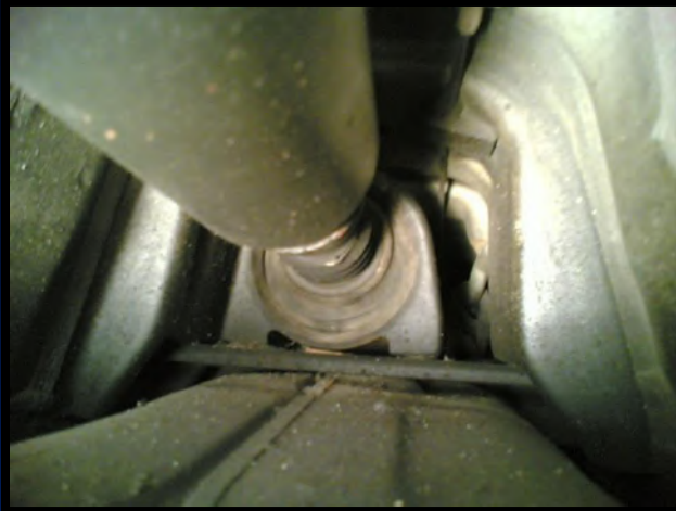
Budowa łożyska podporowego wału napędowego
