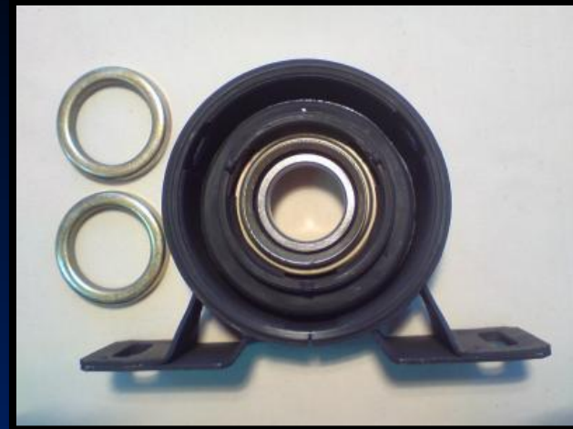
Budowa łożyska podporowego wału napędowego
