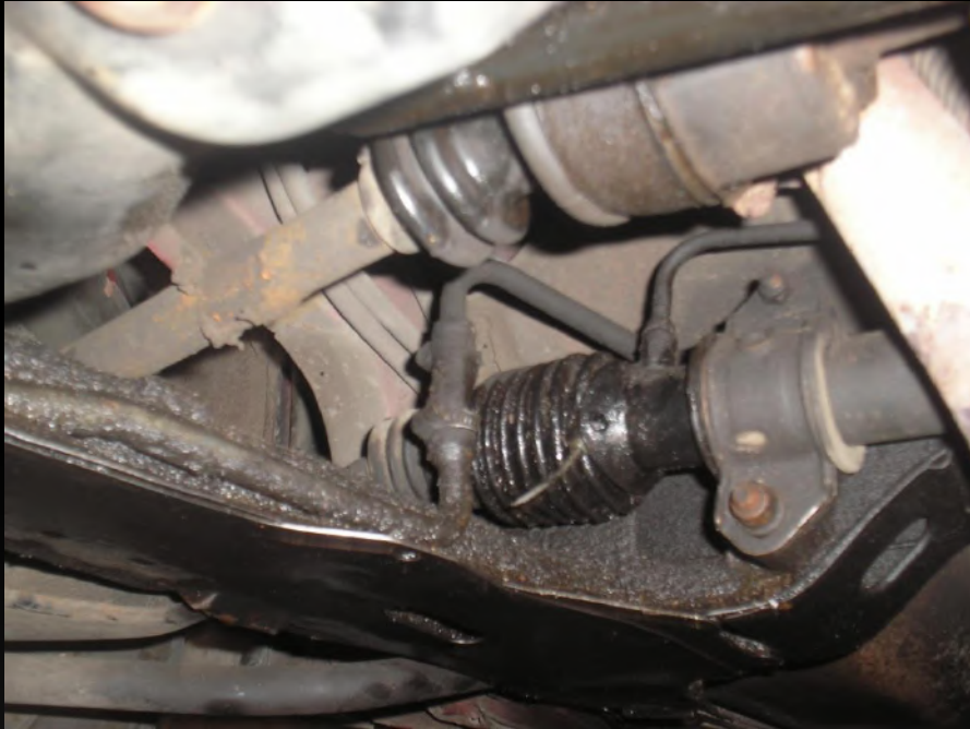
Wyciek płynu wspomagającego
